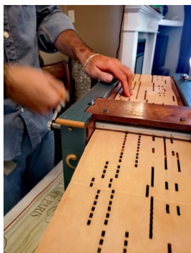
Les cartons perforés sont des morceaux de papier rigides à l'origine des mélodies jouées sur l'orgue de barbarie.
