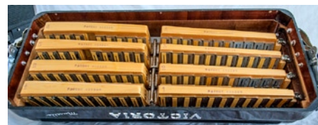
Intérieur du boîtier (main droite) de l'accordéon. On distingue bien les sommiers qui reçoivent les anches libres.
